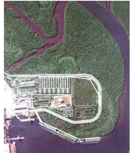
Acima, maquete do projeto: construção de ferrovia interna, prédios administrativos, armazéns e mais três berços de atração; ao lado, planta aplicada à área
